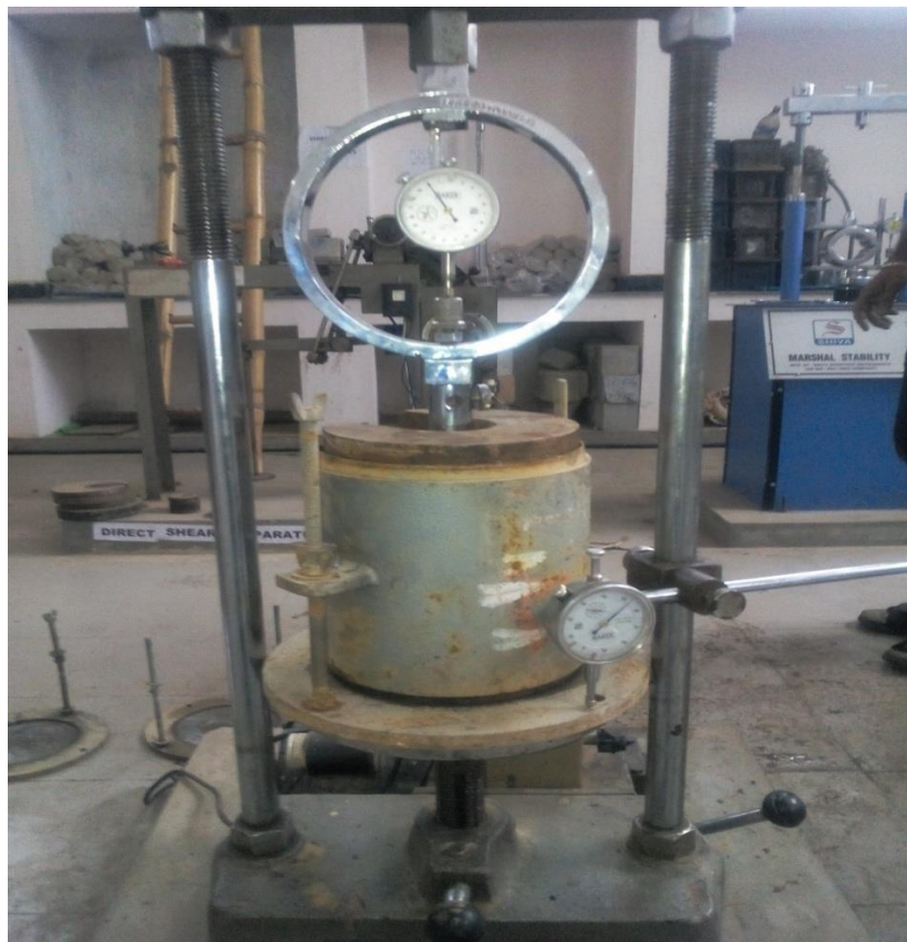
(FIG.3.3.5a) APPARATUS OF CBR TEST
